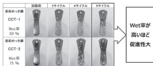
図8 塩水噴霧試験の事例
