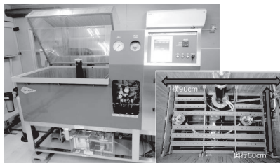
図5 塩水噴霧試験装置
